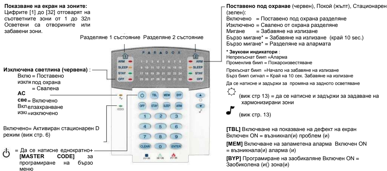
Фигура 3: MG32LRF (32 зонов модул с клавиатура със светоизлъчващи диоди)
