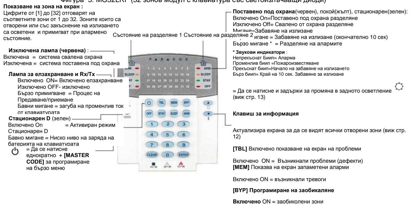
Фигура 3: MG32LRF (32 зонов модул с клавиатура със светоизлъчващи диоди)
