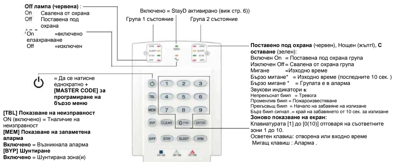
Фигура 1: MG10LEDV (10-зонова клавиатура със светоизлъчващи диоди)
